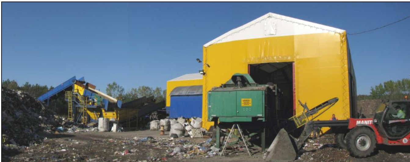
Istniejąca wiata namiotowa z instalacją do frakcjonowania odpadów zmieszanych
