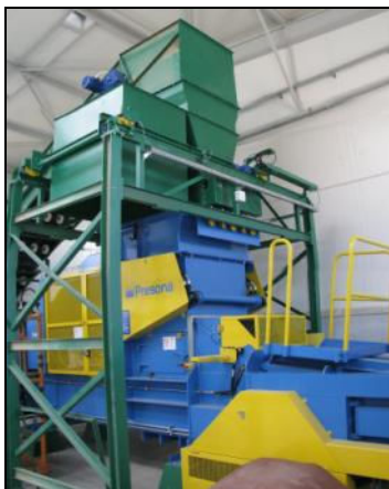
Sortownia odpadów zmieszanych (trybuna sortownicza, sito bębnowe)
