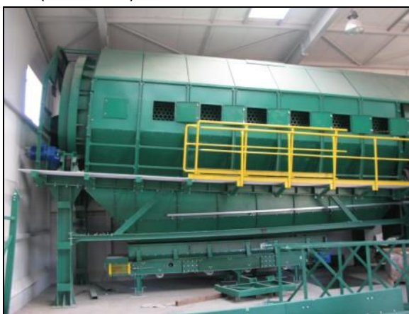
Sortownia odpadów zmieszanych (trybuna sortownicza, sito bębnowe)
