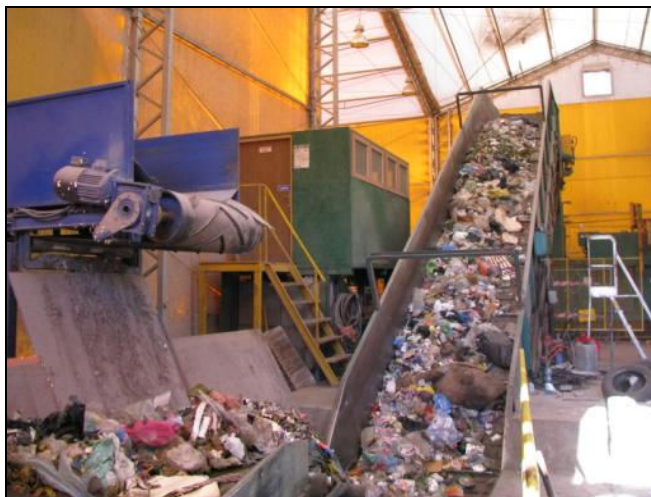
Sito bębnowe i linia mechanicznego przetwarzania odpadów zmieszanych
