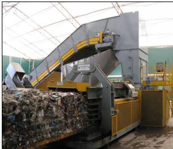
Istniejąca wiata namiotowa z rozdrabniaczem, z prawej prasa kanałowa
