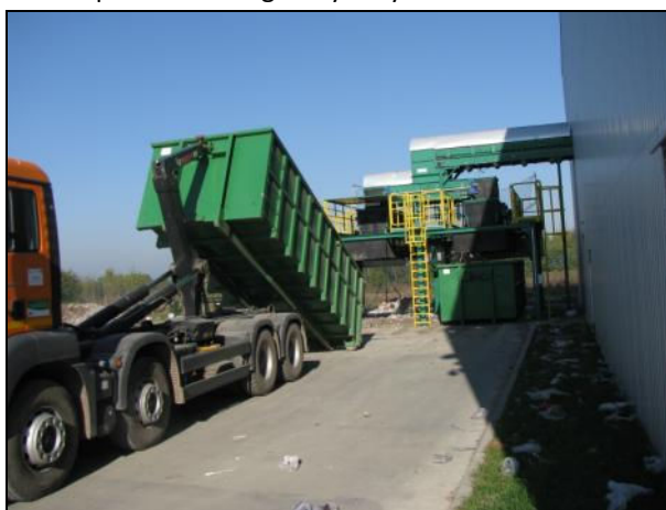
Rozdrabniacz do odpadów zielonych i przetrucarka kołowa do stabilizatu (kompostu), z prawej hakowiec
