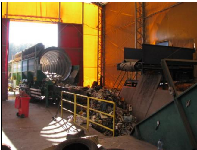
Sito bębnowe i linia mechanicznego przetwarzania odpadów zmieszanych
