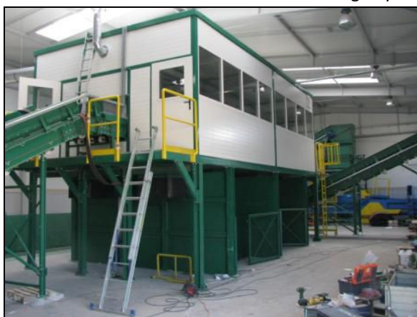
Sortownia odpadów zmieszanych (trybuna sortownicza, sito bębnowe)
