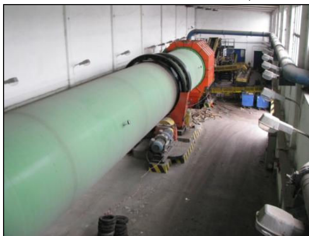
Bioreaktor DANO (część biologiczna przetwarzania), sita frakcyjne
