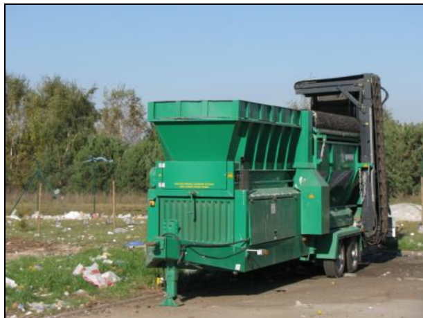
Mobilne sito bębnowe, rozdrabniarka do odpadów wielkogabarytowych
