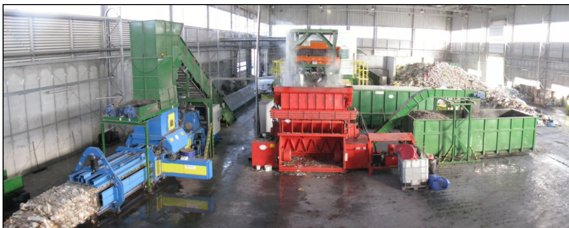
Instalacja do przetwarzania odpadów zmieszanych produkcja komponentów paliwa alternatywnego
