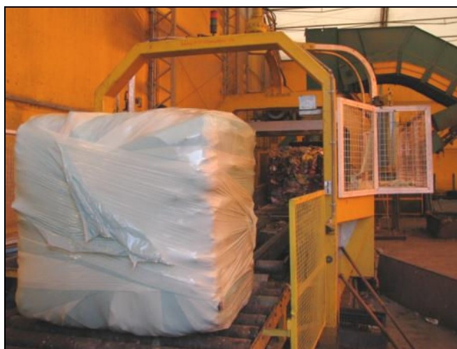
Prasa kanałowa z owijkarką, zmagazynowane odpady, z prawej wjazd na teren ZZO z wagą samochodową
