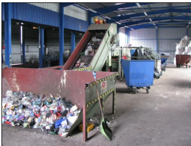
Hala sortowni - zasobnia, linia sortowania ręcznego, prasa do surowców
