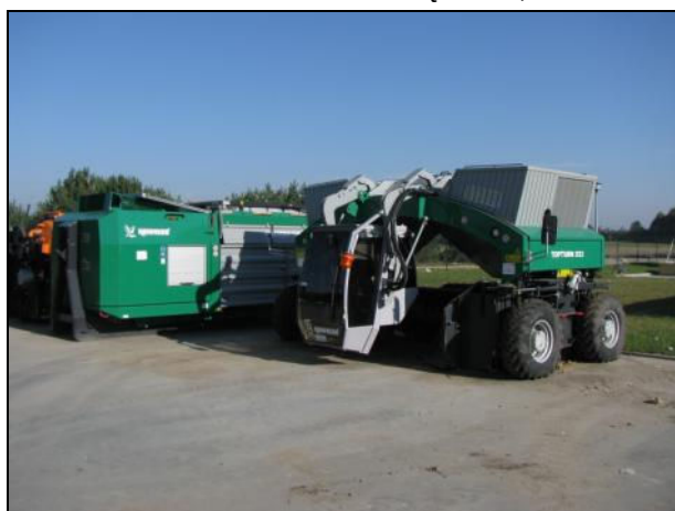
Rozdrabniacz do odpadów zielonych i przetrucarka kołowa do stabilizatu (kompostu), z prawej hakowiec
