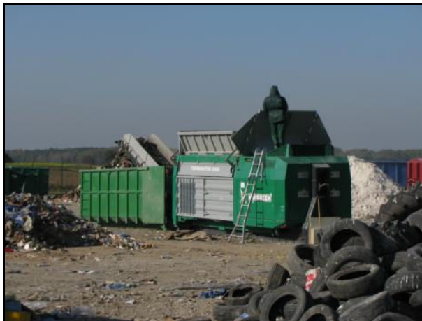
Mobilne sito bębnowe, rozdrabniarka do odpadów wielkogabarytowych
