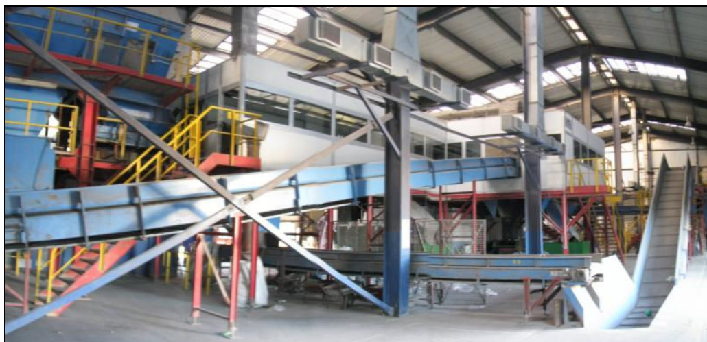
Instalacja mechanicznego przetwarzania odpadów zmieszanych
