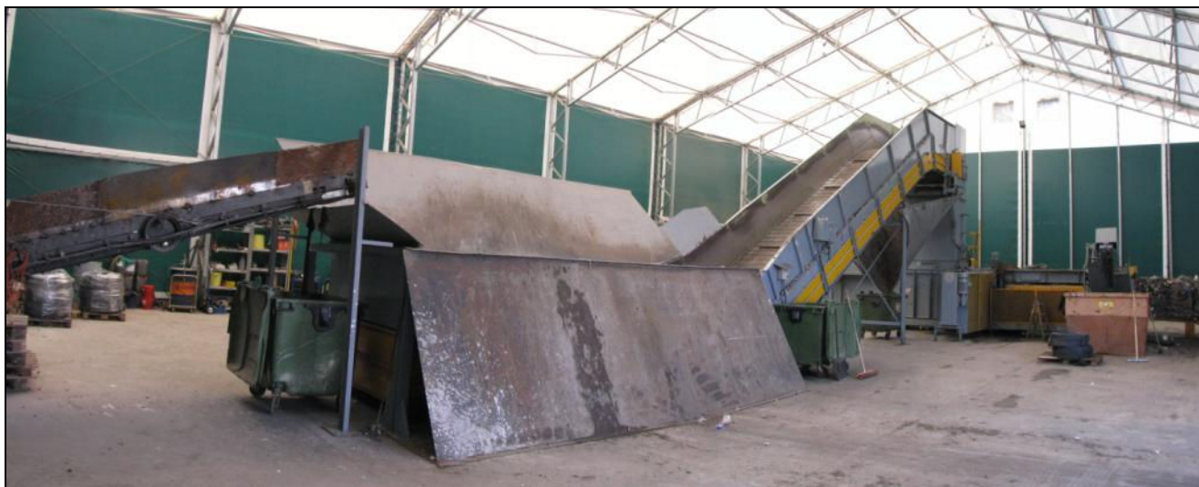
Istniejąca instalacja mechanicznego przetwarzania odpadów zmieszanych
