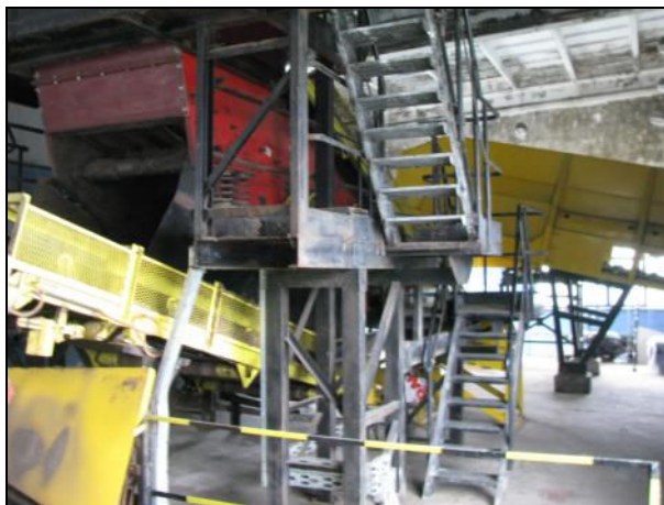
Hala podczyszczania stabilizatu (kompostownia), zestaw sit frakcyjnych
