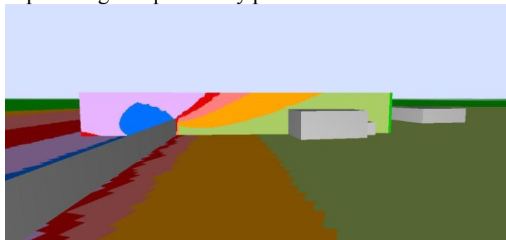
Rysunek 17. Przestrzenny rozkład hałasu po wybudowaniu ekranu akustycznego – widok 3D. Kolorami oznaczono poszczególne przedziały poziomu hałasu.
